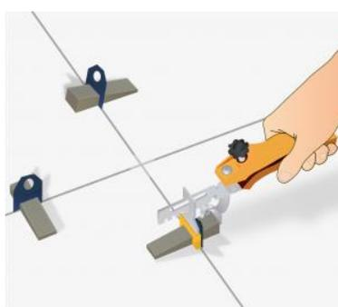
Após a cura e secagem da argamassa, bata lateralmente em cada nivelador com um martelo de borracha. A parte superior do nivelador irá se romper liberando as cunhas.
