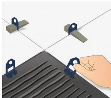
Insira a cunha no nivelador grande eco para começar o nivelamento, em seguida conclua o ajuste com o auxílio do alicate. Sendo uma vez regulado, as demais peças seguirão o mesmo padrão definido no primeiro ajuste, garantindo uma operação uniforme do início ao fim do nivelamento.
