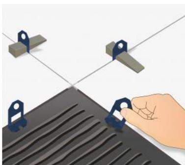
Insira a cunha grande no nivelador para começar o nivelamento, em seguida conclua o ajuste com o auxílio do alicate. Sendo uma vez regulado, as demais peças seguirão o mesmo padrão definido no primeiro ajuste, garantindo uma operação uniforme do início ao fim do nivelamento.
