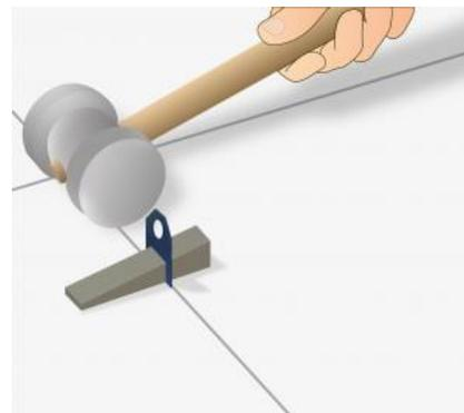
**NOTA:** utilize niveladores de tamanho apropriado conforme orientação de seu arquiteto ou do fabricante do porcelanato/revestimento cerâmico. Se necessário, de acordo com o revestimento utilizado, acrescente um ou mais niveladores em cada lado da peça.
