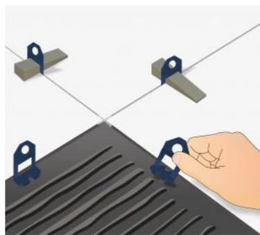
Insira a cunha no nivelador para começar o nivelamento, em seguida conclua o ajuste com o auxílio do alicate. Sendo uma vez regulado, as demais peças seguirão o mesmo padrão definido no primeiro ajuste, garantindo uma operação uniforme do início ao fim do nivelamento.
